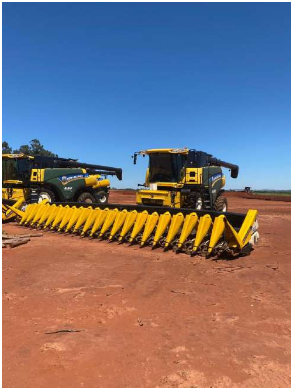
Foto 9 – Plataforma de corte de milho
