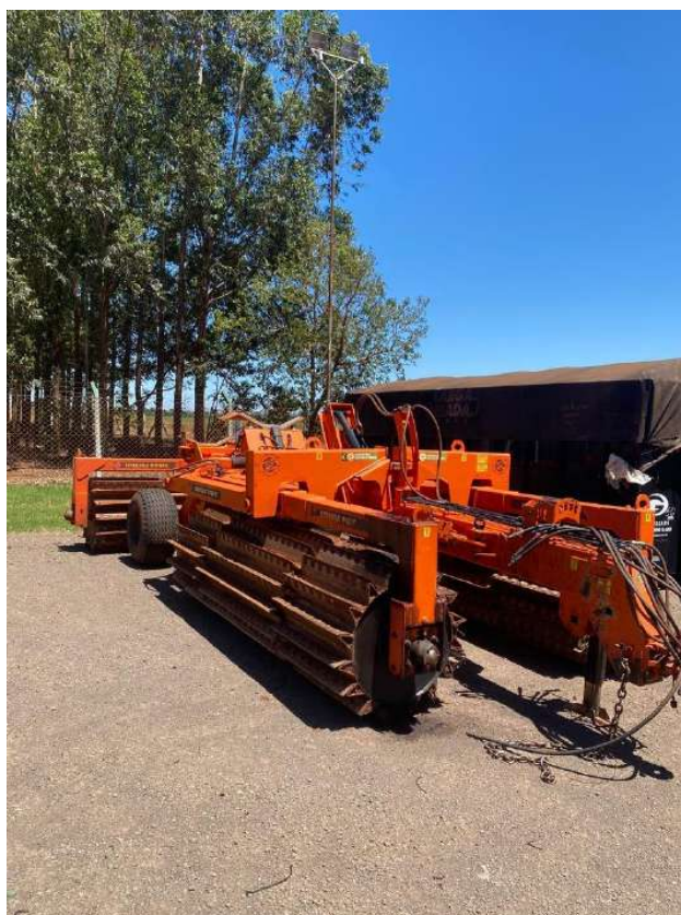
Foto 15 - Fazenda Três Marias – Rolo faca (corte da massa verde da braquiária (ou outra cultura anterior) que é plantada em consórcio com o milho)
