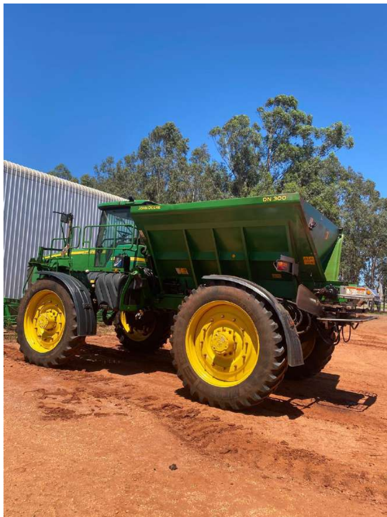
Foto 12 - Fazenda Três Marias – Distribuidor Drybox JD
