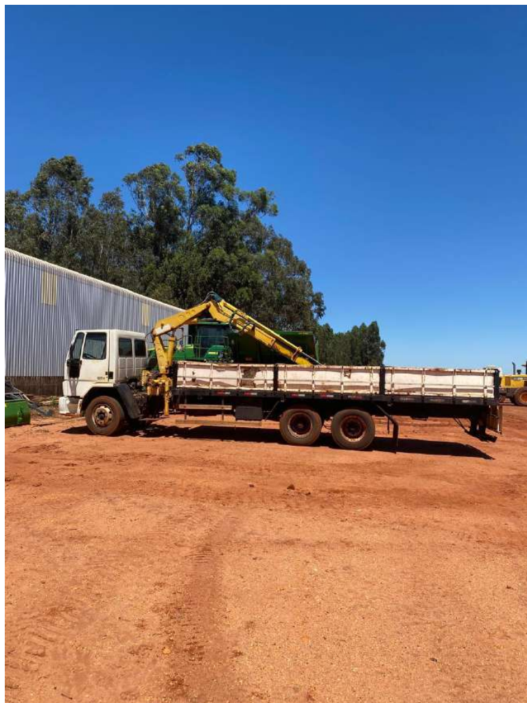
Foto 16 – Fazenda Três Marias – caminhão munck para carregar insumos durante as operações
