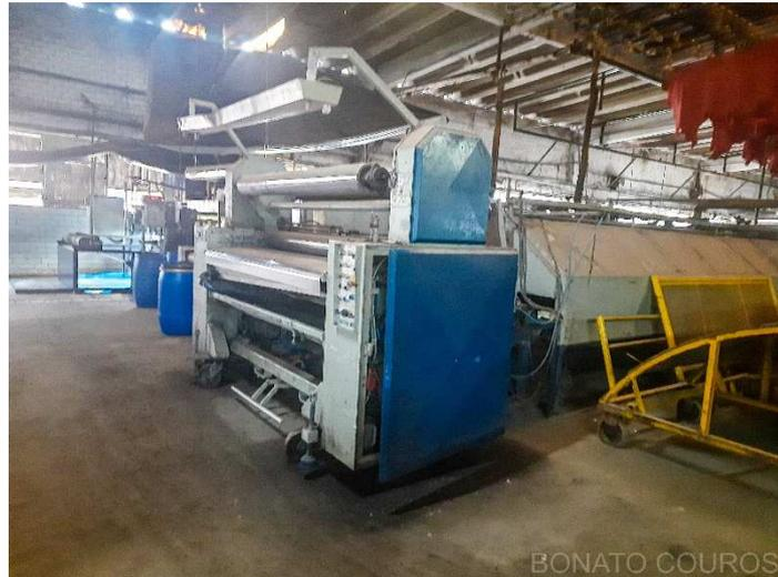
**Descrição: Máquina para pintura de couros por multiponto com acessórios abertura com túnel**
