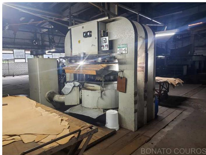
**Descrição:** Prensa hidráulica para acetinar e gravar couros cap. 1800 T
