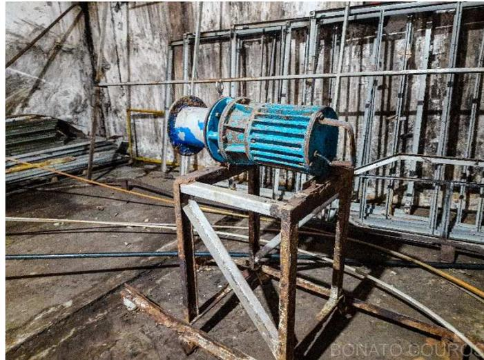
**Descrição:** Aerador submerso com turbo pescador acionamento motor 15HP
