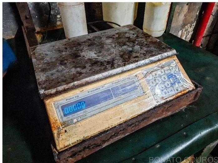
**Descrição:** Balança eletrônica cap. 2500g div. 0,5g para teste de tingimento
