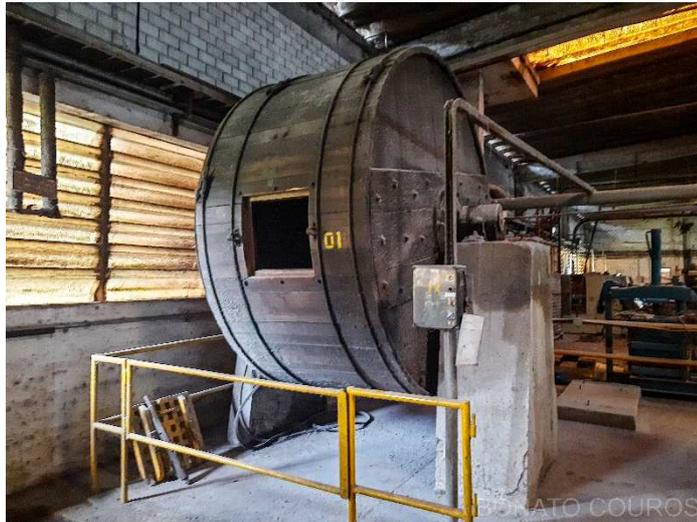
**Descrição:** Fulão de madeira dim. Diâm. 3000 x 1500mm com caixa redutora e motor de 7,5CV
