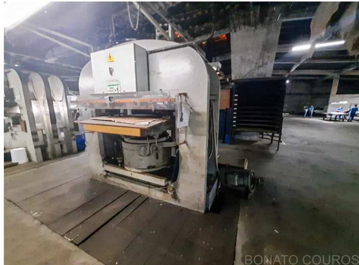
**Descrição:** Prensa hidráulica para acetinar e gravar couros cap. 1500 T
