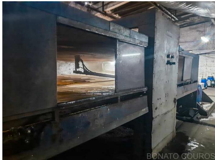
**Descrição:** Túnel de secagem para couros acabados aquecido por vapor
