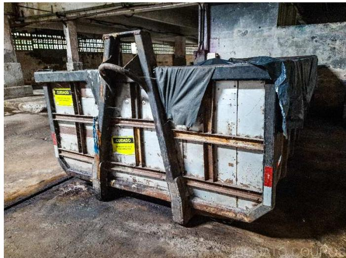
**Descrição: Caçamba em aço carbono para transporte de serragem de couro
