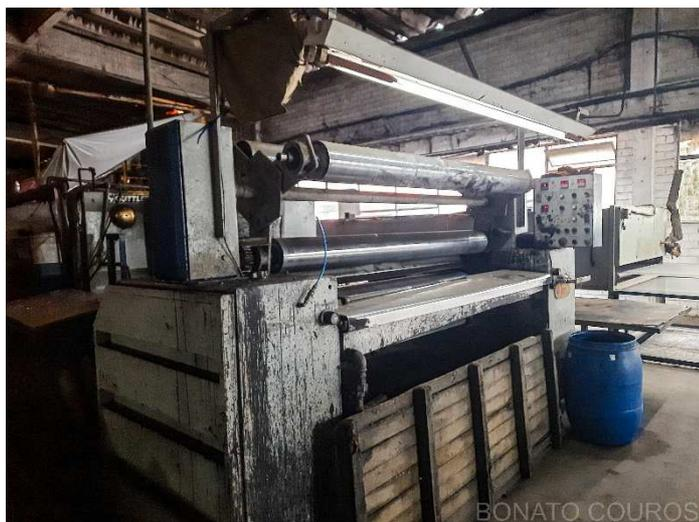
**Descrição:** Cabine de pintura com braço e 2 pistolas para aplicação de laca com túnel de secagem
