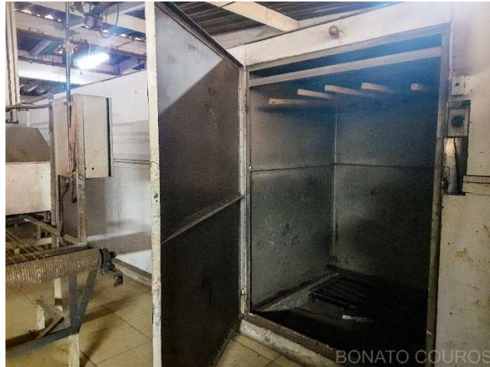
**Descrição:** Cabine de secagem de couros acabados a vapor e elétrica
