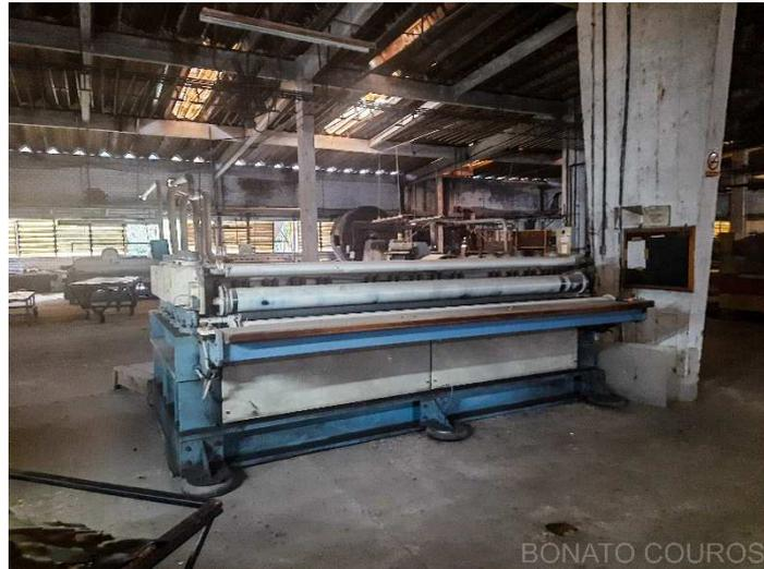
**Descrição: Máquina automática para amaciar e expandir couros com acessórios**
