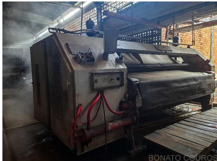
**Descrição:** Enxugadeira/estiradeira eletro hidráulica para couros curtidos inteiros com extrator automático, acessórios e abertura de trabalho 3200mm com Motores de 5 CV e 20 CV
