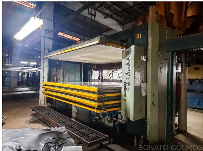
**Descrição: Secadora à vácuo para couros recurtidos e tingidos com 3 mesas em aço INOX polido dim. 3000 x 3980mm composta por bomba de vácuo e bomba para recirculação de água quente**
