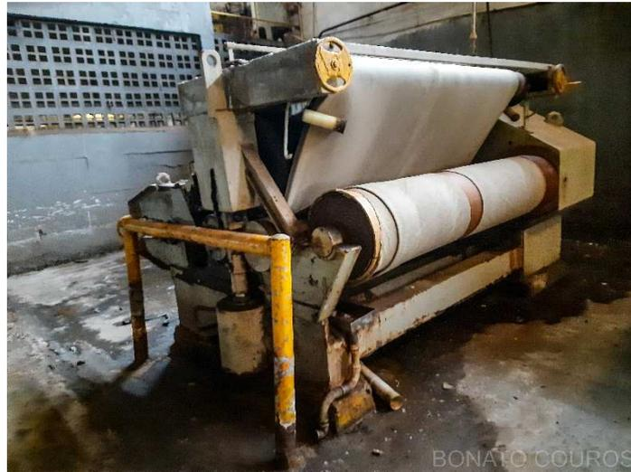
**Descrição:** Enxugadeira abertura 2000mm com Motor de 10 CV Dualpress
