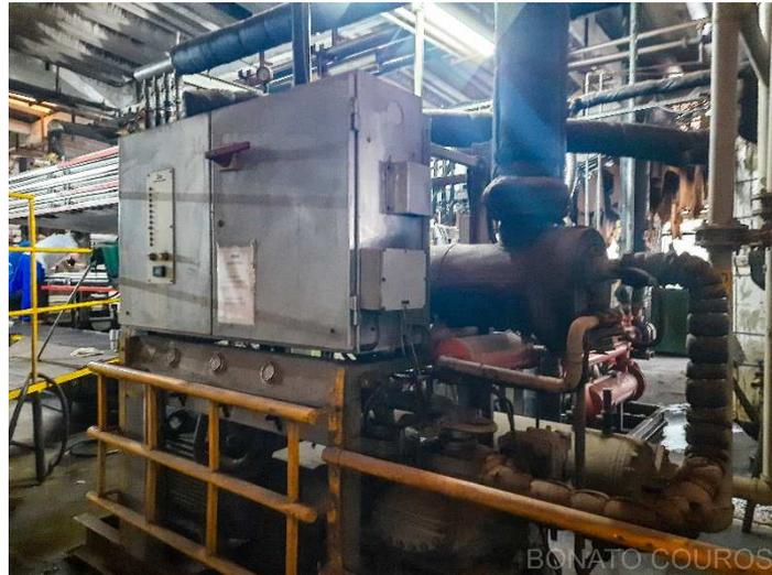
**Descrição:** Secadora à vácuo para couros recurtidos e tingidos com 4 mesas em aço INOX polido dim. 3000 x 7050mm composta por bomba de vácuo, unidade hidráulica, bomba para recirculação de água quente, gerador de água gelada com chiller, tanque reservatório e bombas para recirculação.
