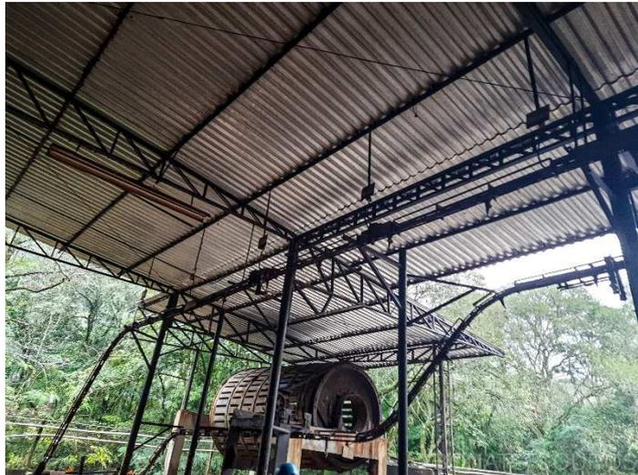
**Descrição: Transportador aéreo para couro em pelo com classificador com caixa de redutora e motor comprimento 55m. l.**
