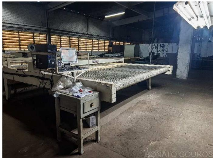
**Descrição: Máquina para medir couro por fotocélula 3400mm com unidade eletrônica**
