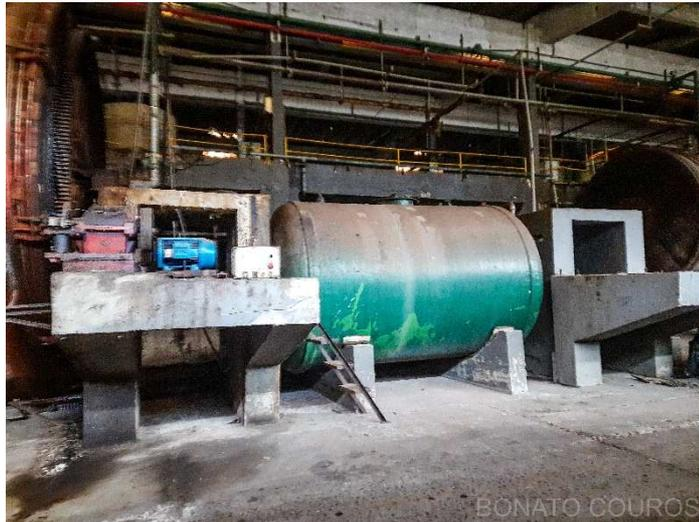
**Descrição:** Tanque em fibra de vidro para banho de cromo dim. Diâm. 2500 x 4458mm cap. 20000l
