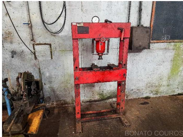
**Descrição: Prensa Hidráulica para Terminais com Bomba Manual**
