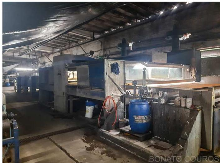
**Descrição:** Cabine de pintura rotativa abertura 3400mm com túnel de secagem aquecido por vapor
