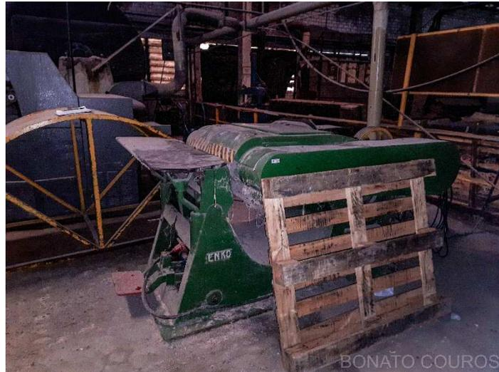
**Descrição: Lixadeira de retoque marca ENKO abertura de 600 mm com força motriz de 10 CV**
