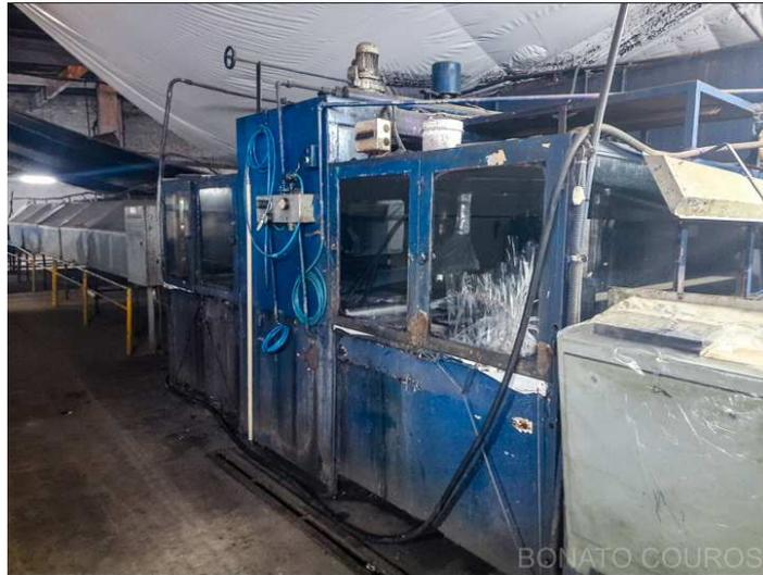
**Descrição:** Túnel de secagem para cabine de pintura manual aquecido por vapor extensão 10000mm
