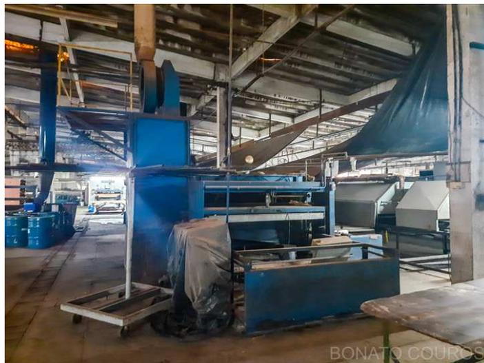
**Descrição:** Cabine de pintura com braço e túnel de secagem com 6 módulos abertura 1800mm
