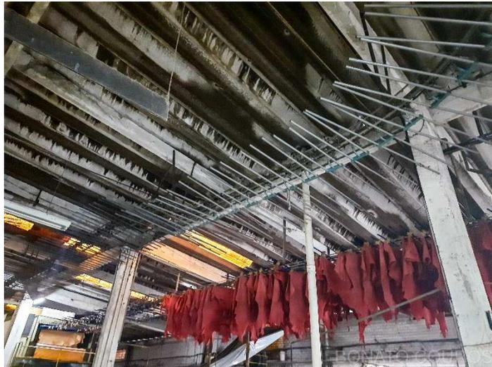
**Descrição:** Secador aéreo para couros recurtidos e tingidos com 1 cabine aquecida por vapor dim. 4000 x 6000mm cada e transportador com 250 m. l. acionamento por redutor e motor 5CV
