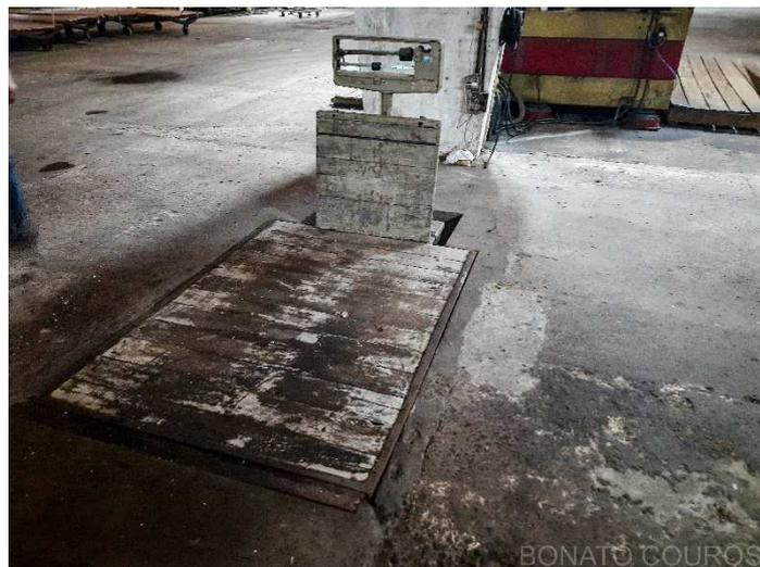
**Descrição: Balança plataforma mecânica de piso dim 1200 x 1800mm cap. 1500kg div. 500g**
