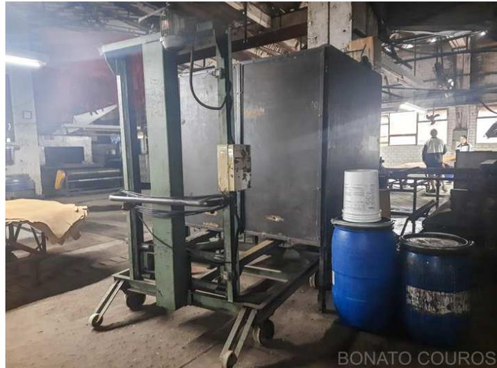
**Descrição:** Elevador eletromecânico sobre estrutura metálica e rodas para troca de chapas das prensas hidráulicas acionamento motor 1,5CV
