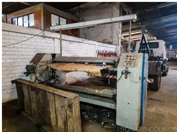
**Descrição: Máquina de pintura tipo multiponto para aplicação de óleo**
