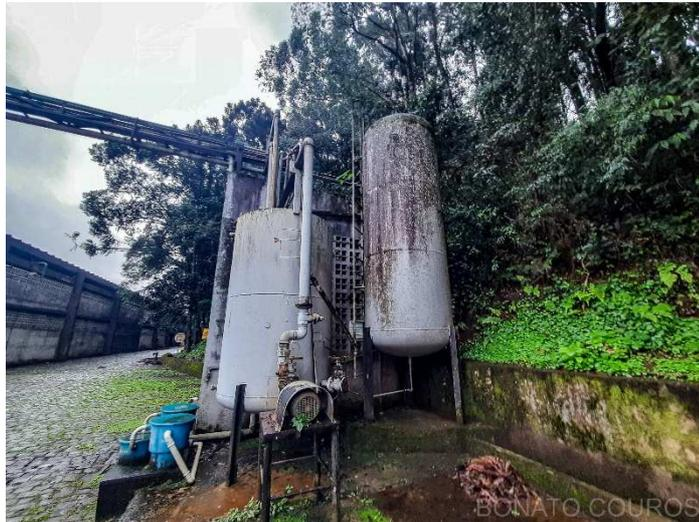
**Descrição: Tanque em Aço Carbono Pulmão de Ar – 1500X3600MM**
