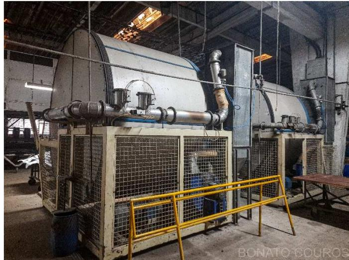
**Descrição: Fulão de INOX para bater couros com controle programável de temperatura**
