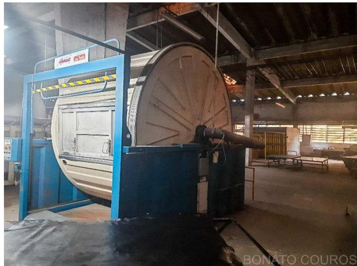
**Descrição: Fulão de INOX para amaciar couros com sistema de filtragem de ar**
