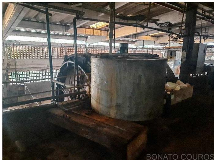
**Descrição:** Barrica para Mistura de PQ com Motor de 1 CV
