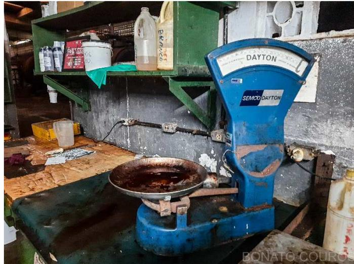
**Descrição:** Balança Manual Capacidade 15 kgs para teste de tingimento
