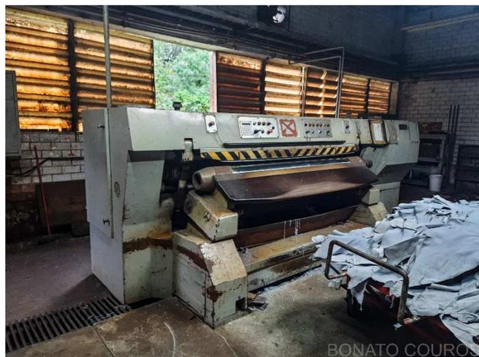
**Descrição:** Rebaixadeira para couro abertura 1800mm com motor da navalha de 75CV, motor da Bomba Hidráulica de 12,5 CV, motor da espessura de 0,75 CV, motor do transportador do esmeril de 0,75 CV, Motor do esmeril de 3 CV e motor da ventoinha (para não enrolar o couro) de 2 CV
